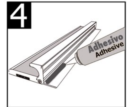
Aplicar adhesivo en el interior del tirador
